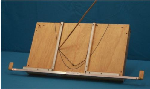
Figura 1 - Fotografia del parabolografo a filo
